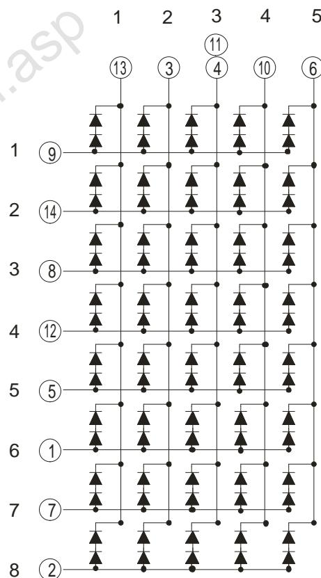
驱动电压为：正向电压×2 不同颜色的正向电压值不同,详见第二页光电参数表。
