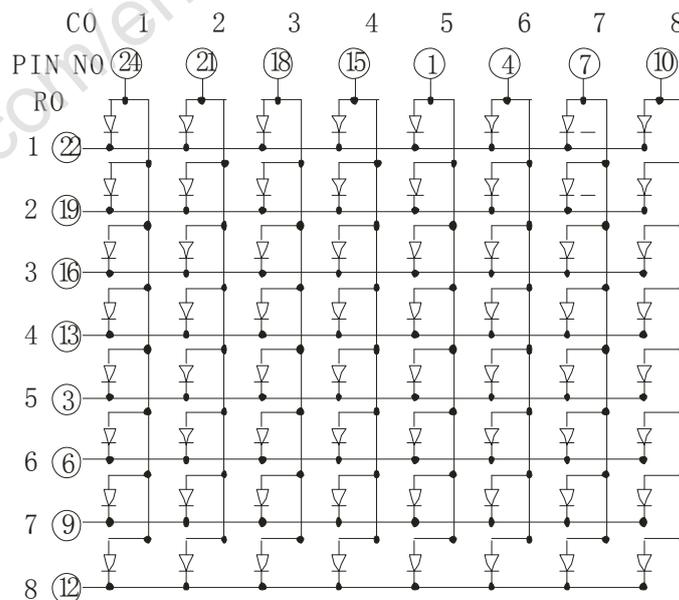
驱动电压为: 正向电压×1 不同颜色的正向电压值不同,详见第二页光电参数表.
