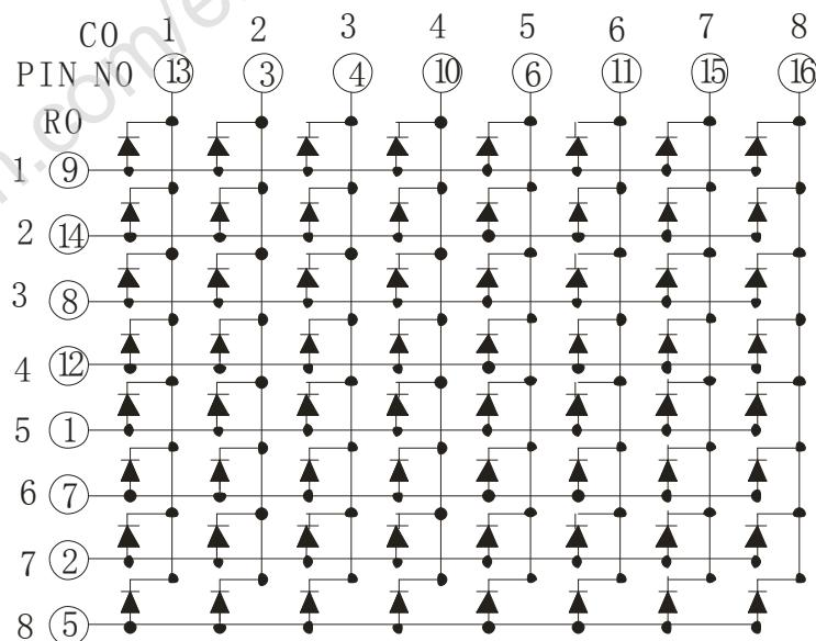
驱动电压为：正向电压×1 不同颜色的正向电压值不同,详见第二页光电参数表.
