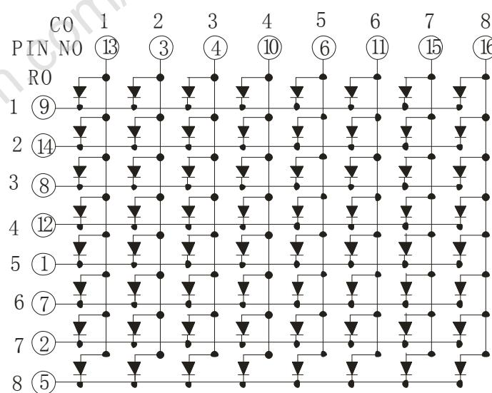
驱动电压为：正向电压×1 不同颜色的正向电压值不同,详见第二页光电参数表。
