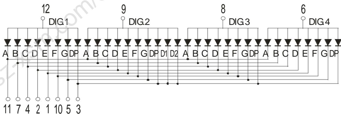
段驱动电压为： 正向电压×1
