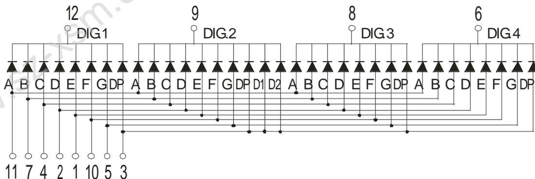
段驱动电压为: 正向电压×1
