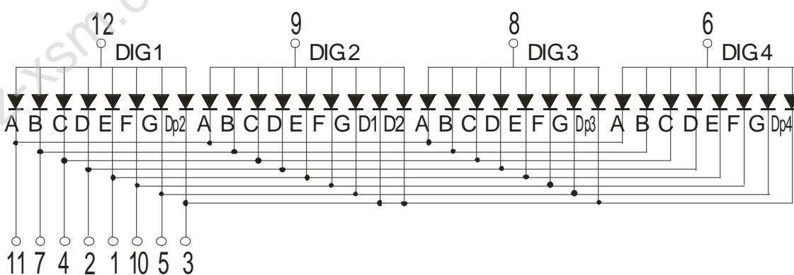
段驱动电压为: 正向电压×1
