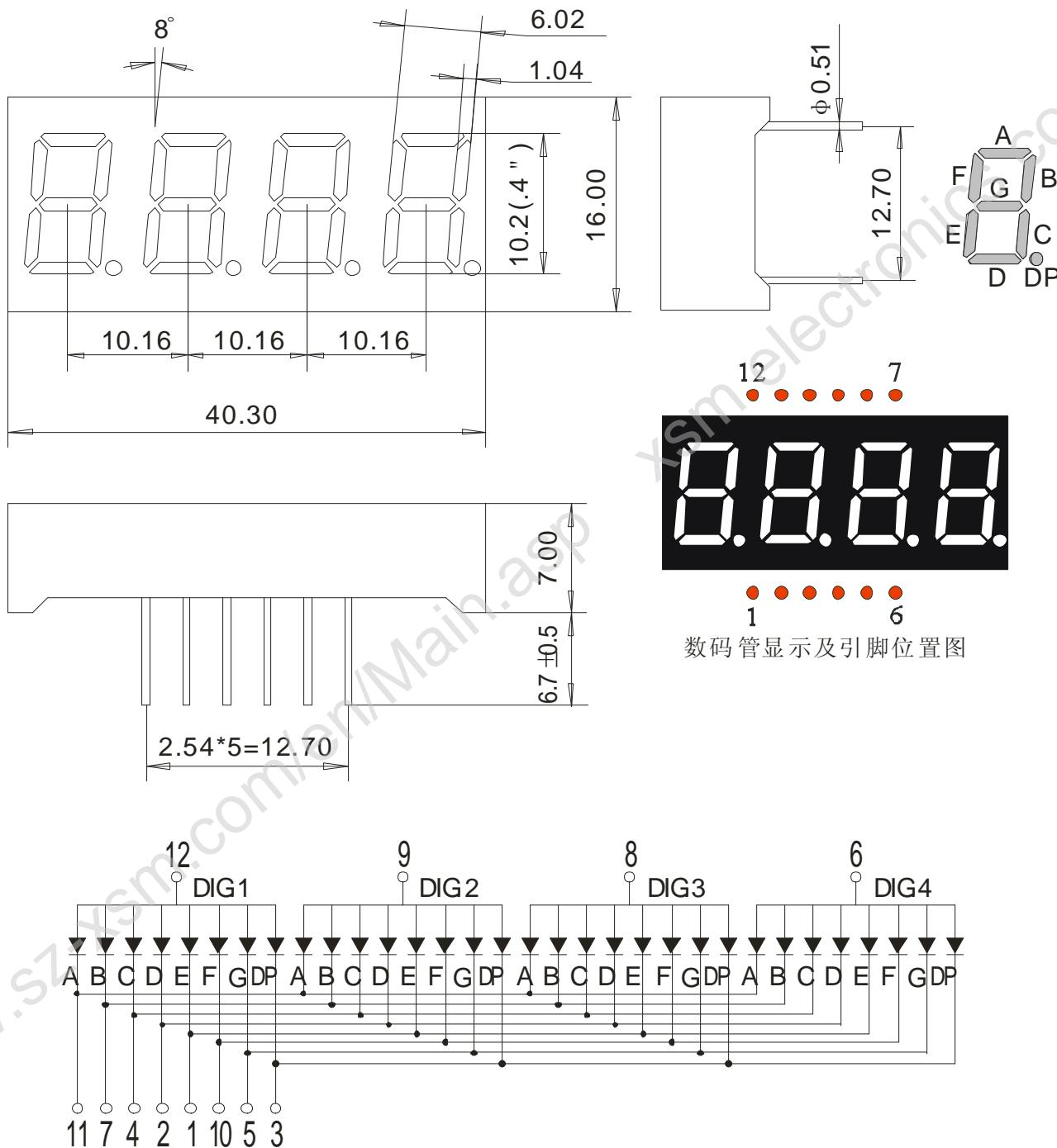
段驱动电压为: 正向电压×1
