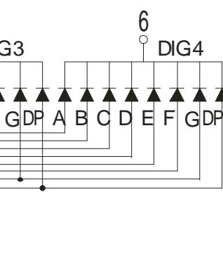
段驱动电压为: 正向电压×1
