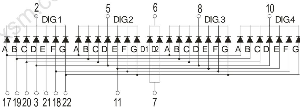
段驱动电压为: 正向电压×1
