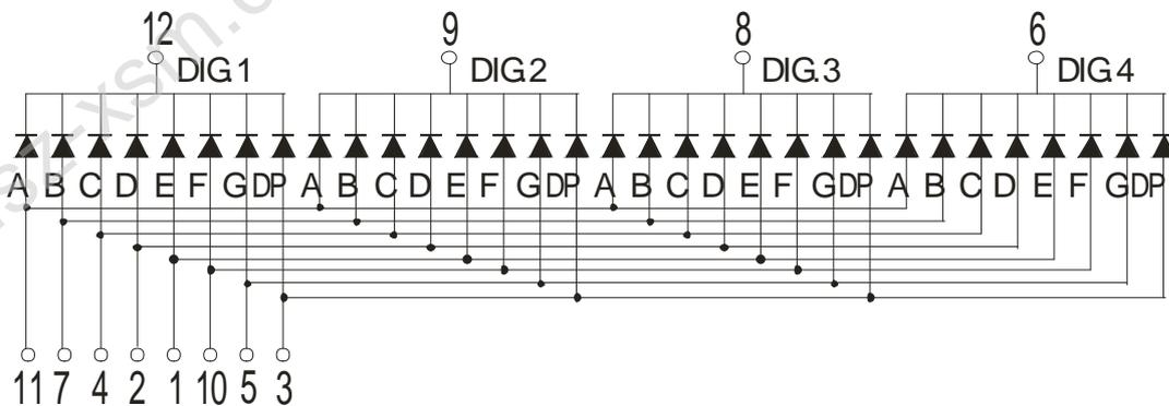
段驱动电压为: 正向电压×1
