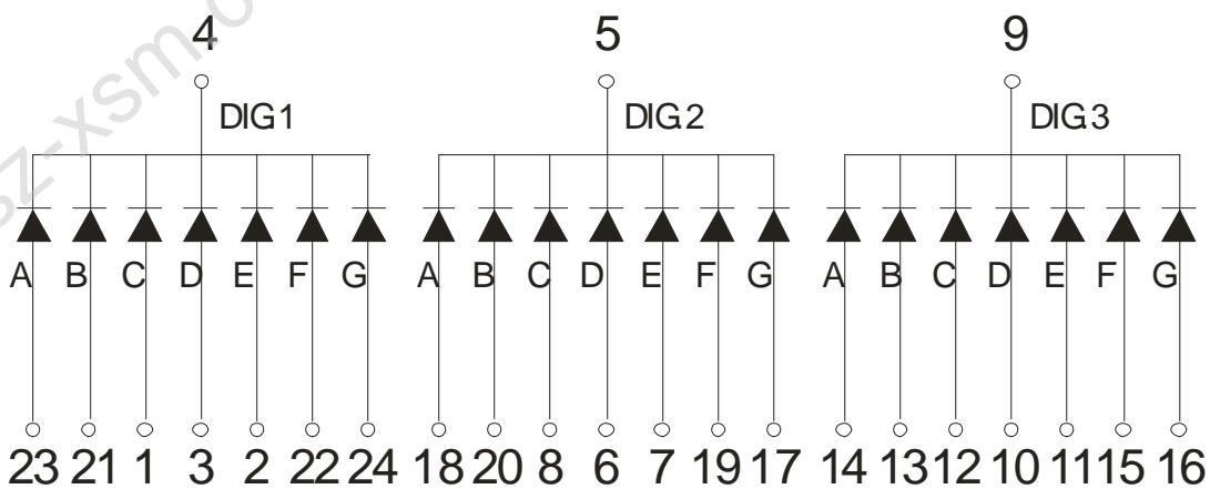
段驱动电压为: 正向电压×1
