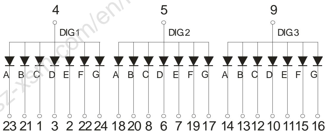
段驱动电压为： 正向电压×1
