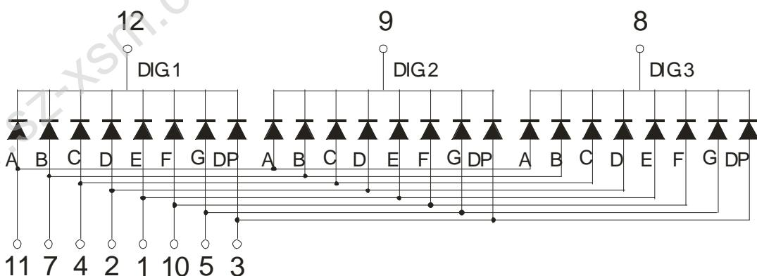
段驱动电压为: 正向电压×1
