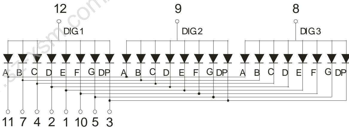
段驱动电压为: 正向电压×1
