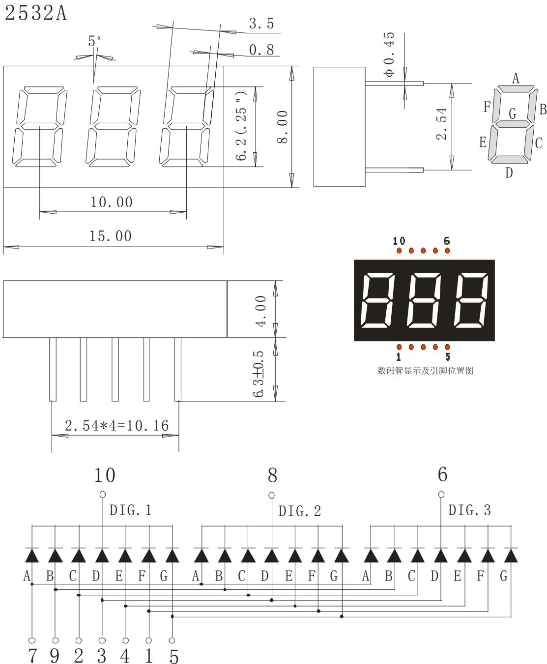
段驱动电压为: 正向电压×1
