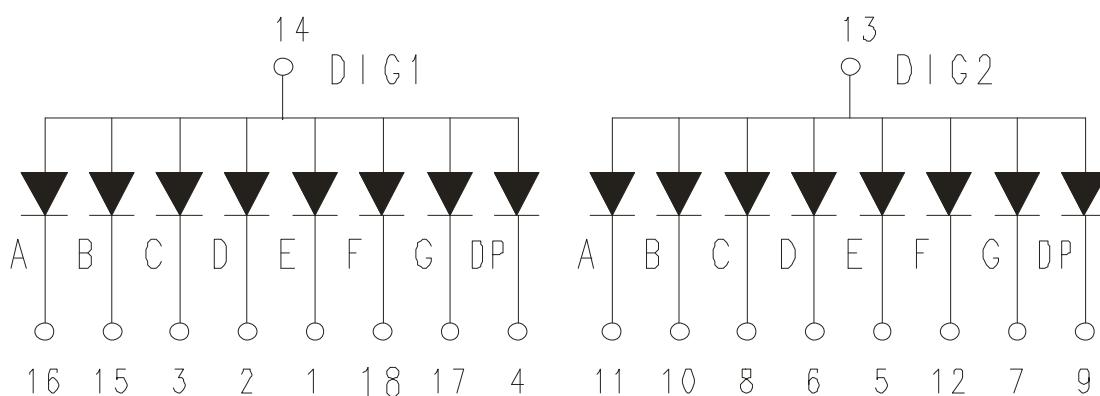
段驱动电压为: 正向电压×1
