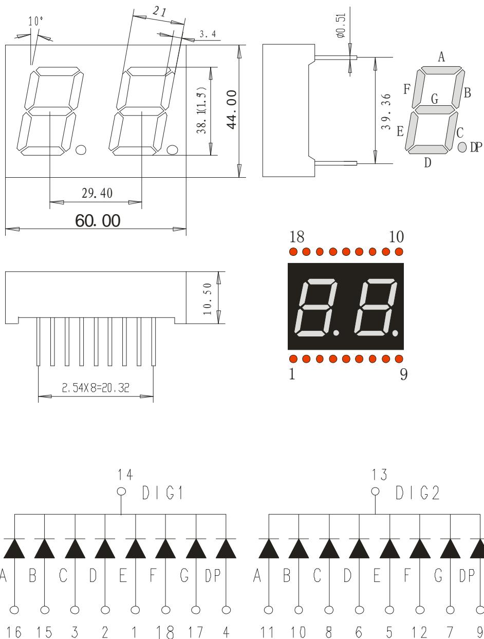
段驱动电压为: 正向电压×1
