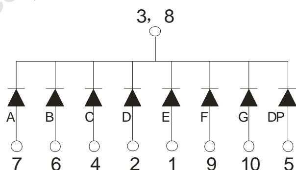
段驱动电压为: 正向电压×1
