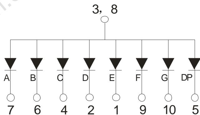
段驱动电压为: 正向电压×1
