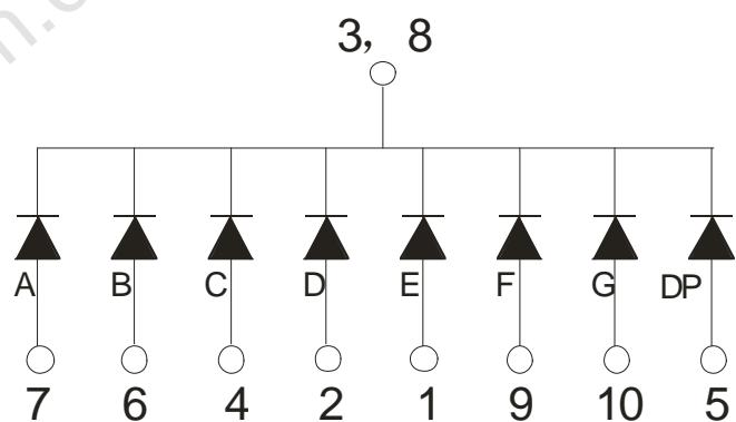
段驱动电压为: 正向电压×1
