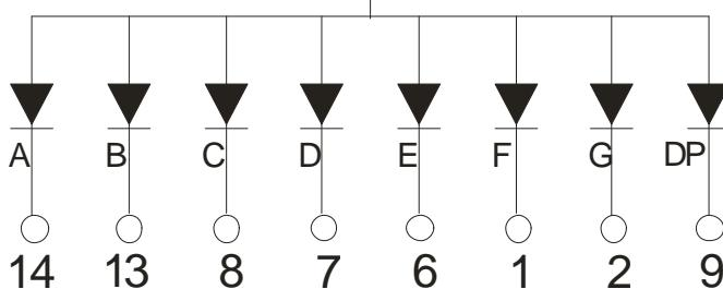
段驱动电压为：正向电压×1
