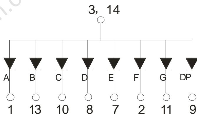
段驱动电压为: 正向电压×1
