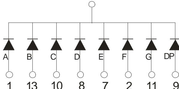
段驱动电压为: 正向电压×1
