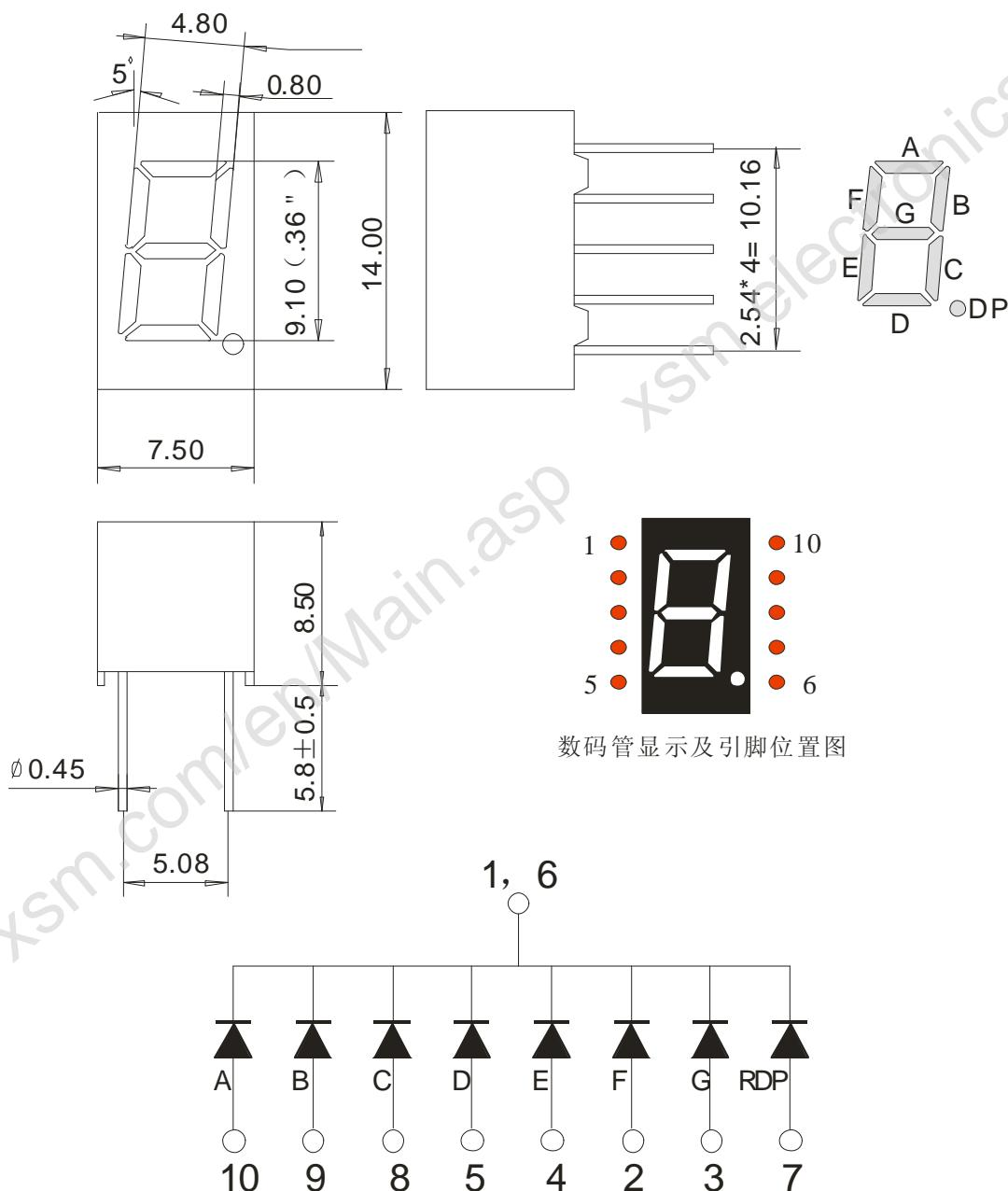
段驱动电压为: 正向电压×1
