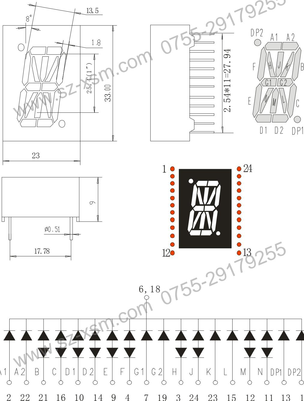
驱动电压为: A1、A2、D1、D2、G1、G2、DP1、DP2 正向电压×1
