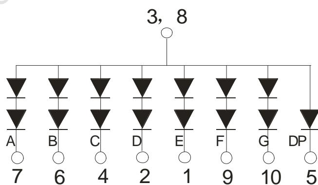
段驱动电压为: 正向电压×1
