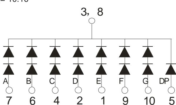
段驱动电压为: 正向电压×1
