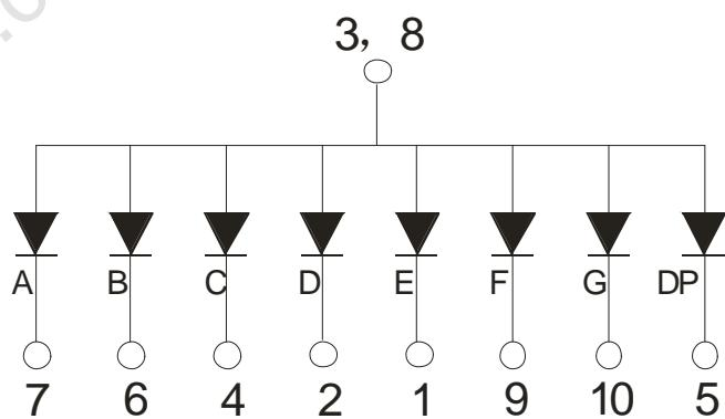
段驱动电压为：正向电压×1
