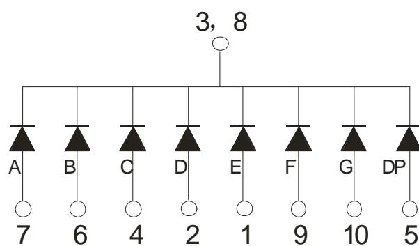
段驱动电压为: 正向电压×1
